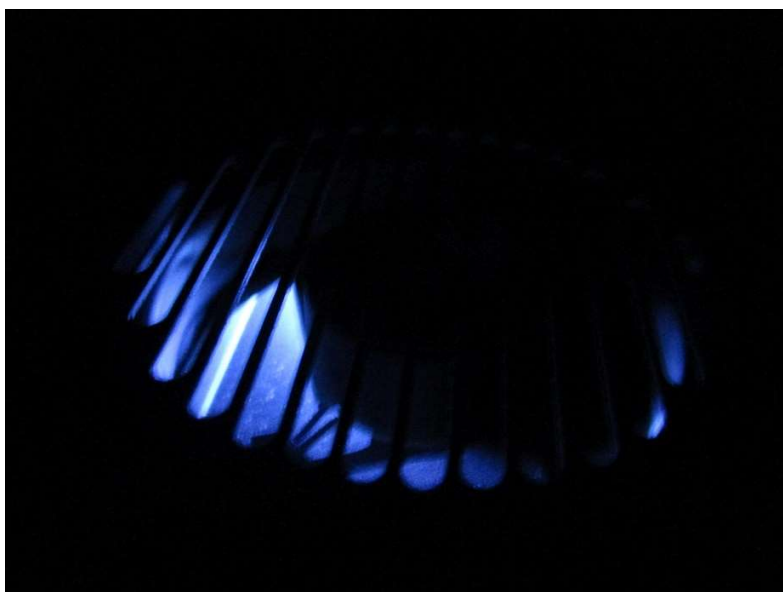
Abbildung 3: zugängliche Strahlung am Luftauslass
