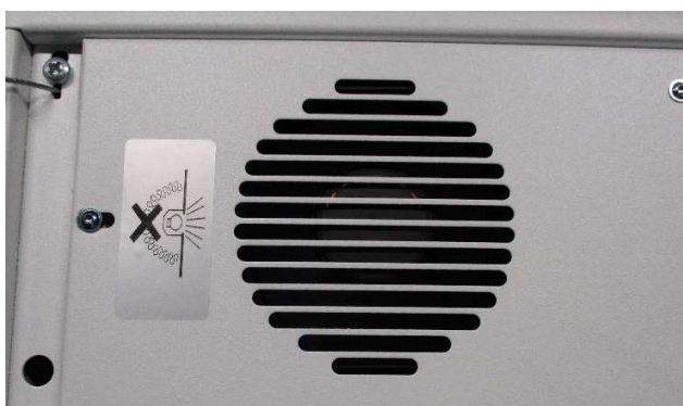
Abbildung 6: Beschriftung am Luftauslass
